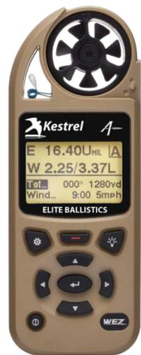
Pour appairer un Kestrel, celui-ci doit être en mode PC/Mobile, avec la fonction PIN désactivée. Il doit utiliser le firmware 1.53 ou plus récent, et être un Kestrel 5700 ou une variante plus récente avec Applied Ballistics.
